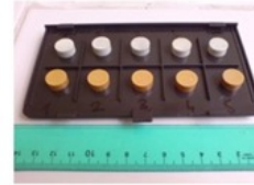
Resim 9. Sinterlenmiş UO_2 (siyah)ve ThO_2 (beyaz) peletleri ve zircaloy zarfta tapa kaynak röntgeni
