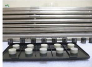
Resim 9. Sinterlenmiş UO_2 (siyah)ve ThO_2 (beyaz) peletleri ve zircaloy zarfta tapa kaynak röntgeni
