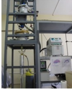
Resim 7. Yarı otomatik iç jelleştirme düzeneği ve bu yöntemle üretilen UO_2 peletleri
