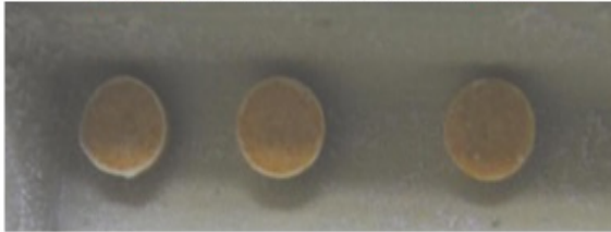
ÇNAEM'de Sol-Gel Yöntemiyle Üretilen (U,Th)O 2 Nükleer Yakıt Peletleri
