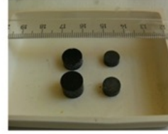
Resim 7. Yarı otomatik iç jelleştirme düzeneği ve bu yöntemle üretilen UO_2 peletleri
